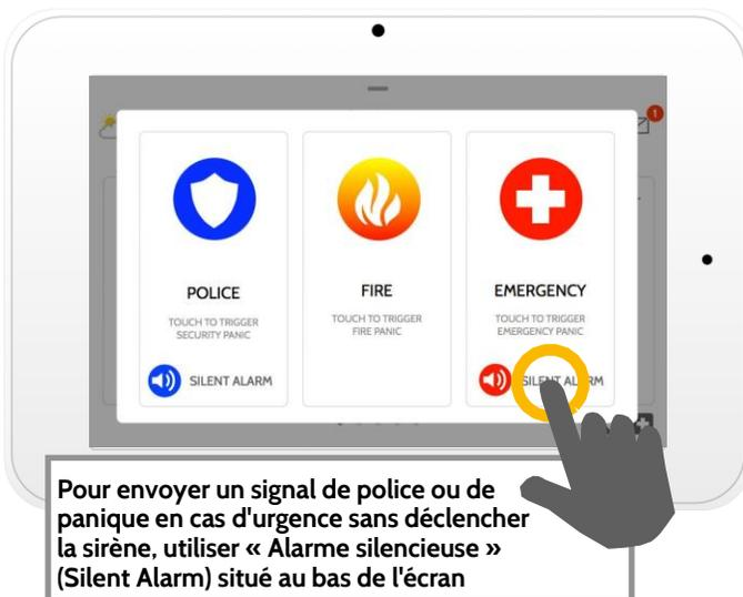
Pour envoyer un signal de police ou de panique en cas d'urgence sans déclencher la sirène, utiliser « Alarme silencieuse » (Silent Alarm) situé au bas de l'écran
